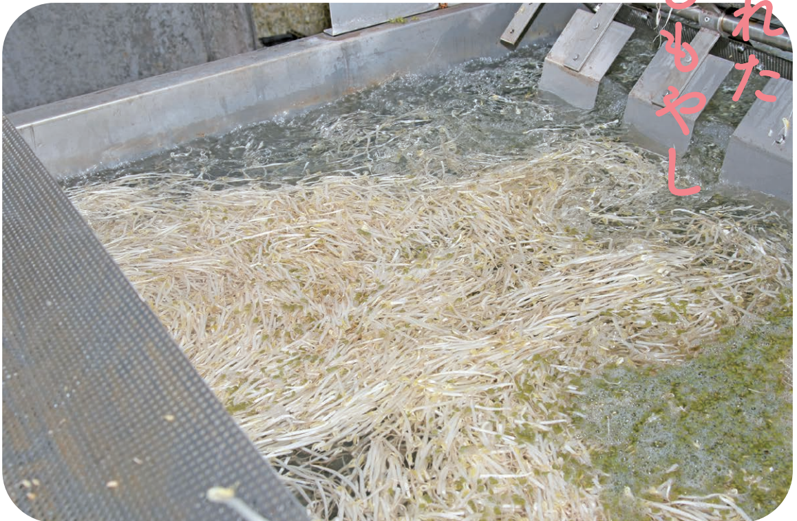
写真はもやしの洗浄水槽。バブル洗浄方式により、豆の皮を取り除きながら洗浄します。洗浄する水にも、もちろん地下水を使用。不純物が極めて少ない地下水で成長し、洗浄されることで、色の白い美しいもやしに仕上がるそうです。
