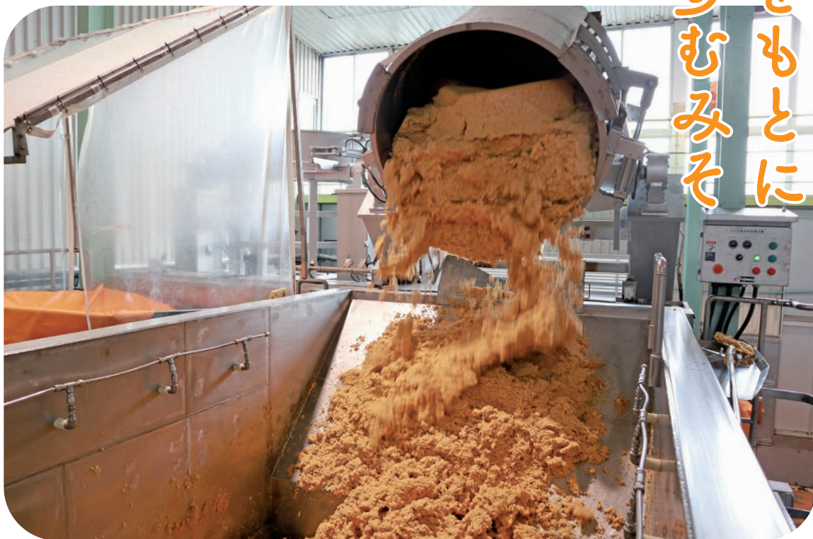
【米麦あわせみそ】は、米と麦を原料の段階で合わせて、二度蒸してから麴を仕込みます。そのため、麦と米の粒がつぶれにくく、香りやうまみを逃しません。写真は、発酵・熟成が終了し、みそ全体が均一になるよう加工している様子。
