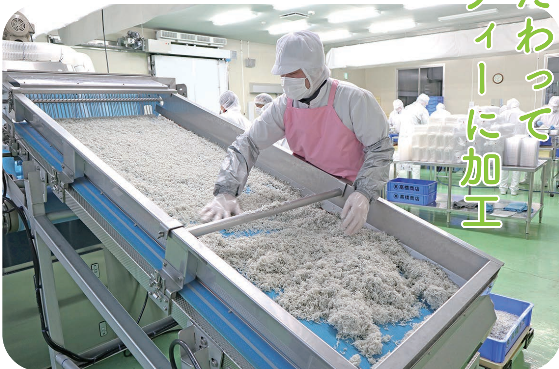
写真はしらすの製造工程。原料はオートメーションによる洗浄、塩ゆで、乾燥の工程を経る間に、大きさの選別や異物の除去が行れた後、一旦冷却されます。その後、色彩選別機にかけられ、さらに人の目によるチェックを経て、人の手によって計量、包装が行われています。
