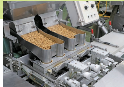
納豆の充填から酸酵室へ運ぶケース入れまで行う自動生産ライン。
