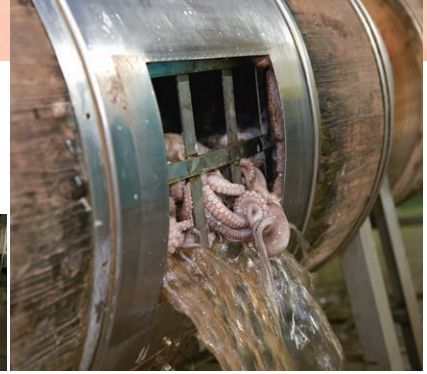
梅を回転させながら、タコの洗浄、塩もみなどを行います。
