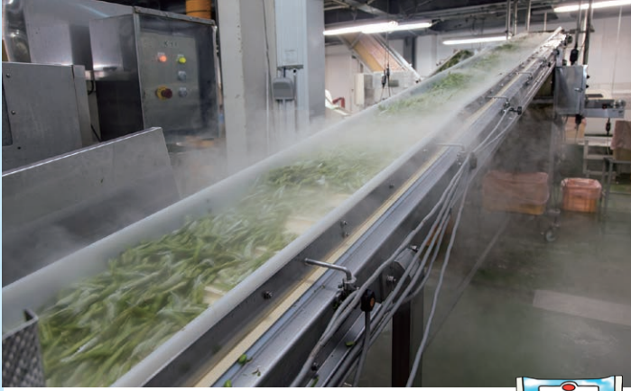
マイナス196℃の液体窒素で急速冷凍した枝豆。ブランチング(加熱)から凍結までの工程はオートメーション化されています。
