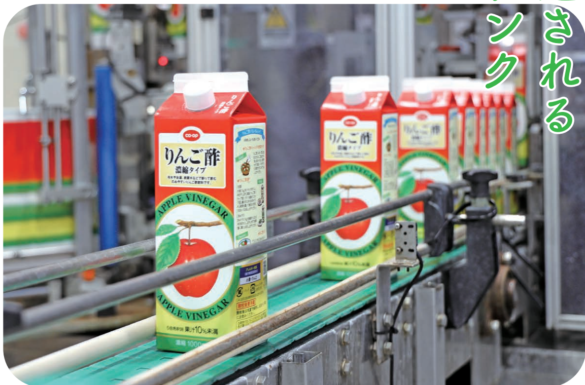
加熱しながらかく拌したりんご酢を90℃近い温度のまま容器に充填することにより、容器も加熱殺菌しています。充填後、冷水シャワーの中を通り、45℃以下に冷却。段ボール詰めは、1本1本手に取り、目視でバックに傷や漏れがないかを確認しながら手作業で丁寧に行われています。
