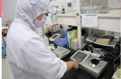
原料を調合した後、糖度、酸度、PHの検査を行った上で、パック詰めの工程に進みます。
