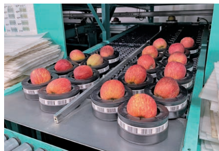
収穫したりんごを1個ずつトレーに置いて、光センサーで色・サイズ・糖度・内部褐変(変色)等をチェックしています。
