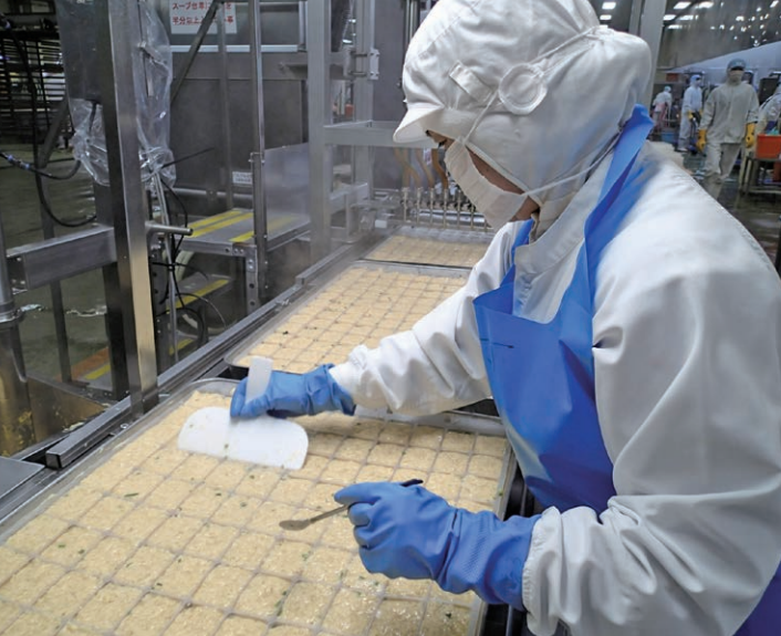
スープから飛び出した具材が包装を傷つけないように、専用のヘラを使って手作業で表面をならしています。
