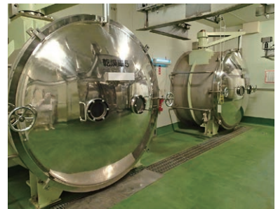
フリーズドライ製法の「ドライ」の工程を担当する真空乾燥機。
