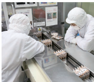
個包装された後、重量チェック、金属探知機、X線探知機を経て、包装に異状がないかを目視でチェック。
