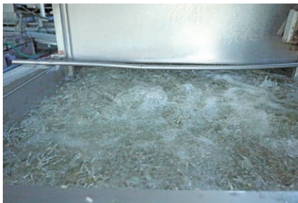
もやしはバブル洗浄方式により、豆の殻を取り除きながら地下水で洗浄。工場内の毎日の洗浄にも地下水が使用されています。
