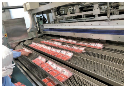
真空パックした商品は90℃以上で約35分の殺菌加熱をした後、冷却して出荷されます。
