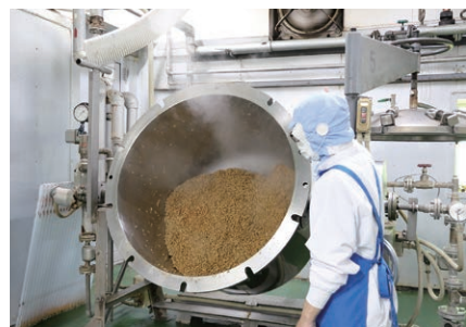
120℃～130℃の釜で約1時間蒸煮した大豆に、納豆菌を噴霧して、充填の工程へ。
