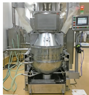
1回で約100kgの生地を練る大型ミキサー。
