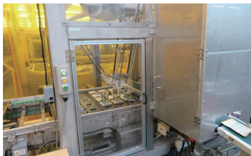
出来上がったレトルトパウチの商品を、120℃で23分殺菌を行う殺菌装置。
