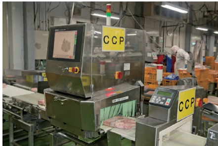
機械と人による工程を合わせて丁寧に処理加工、検査を行っています。写真はX線検出器と金属検出器。
