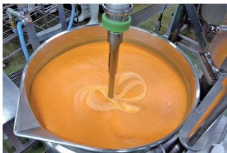
カットした野菜を釜の中で加熱したら、早急に冷却。その後、手作業でトレイに充填。
