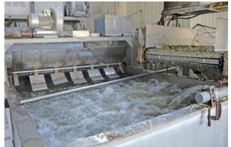
バブル洗浄方式により、豆の殻を取り除きながら地下水で洗浄。豊富な地下水は工場内の清掃にも使用されている。
