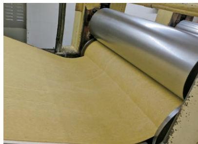
原料をミキシングして出来上がった生地は、板状に伸ばされてスティック状に型抜きされます。
