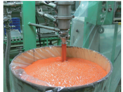
湯通ししたにんじんを搾汁、殺菌後、濃縮して水分を飛ばし、ドラム原料として冷凍保管。
