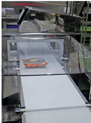
包装後、X線と金属検出器で異物混入をチェック。
