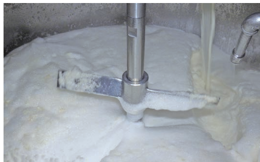
浸漬した大豆をすり潰して、豆乳とおからに分離。
