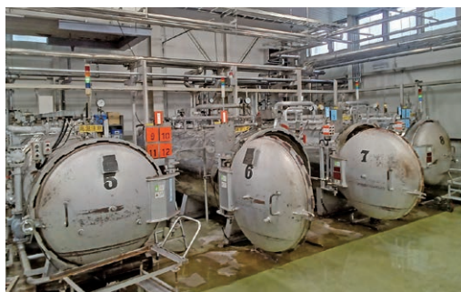
充てんした缶またはパックを、巨大な圧力釜で加熱・殺菌。
