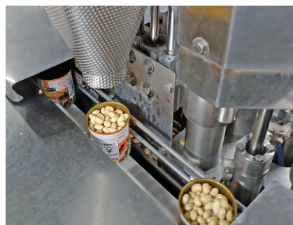
缶の底側から充てんして、蓋をしながら真空状態にします。
