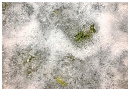
1、2回目の洗浄では下からエアを送り、3回目の洗浄では横から強力なジェット水流をあてています。
